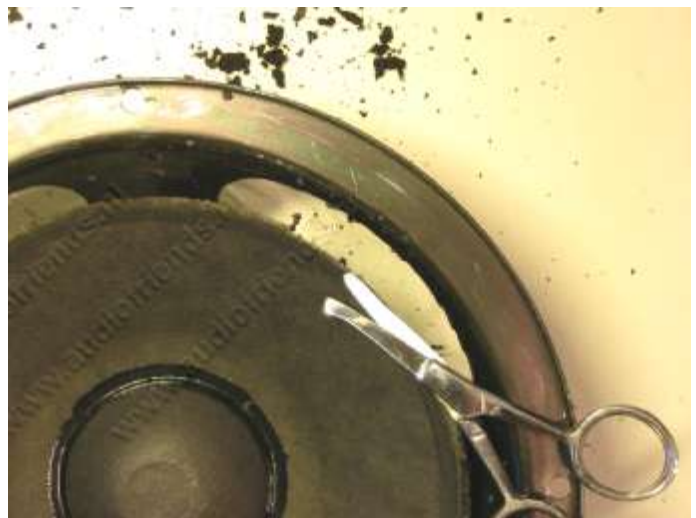
14. Deze knippen we er voorzichtig af met een klein schaarje.
