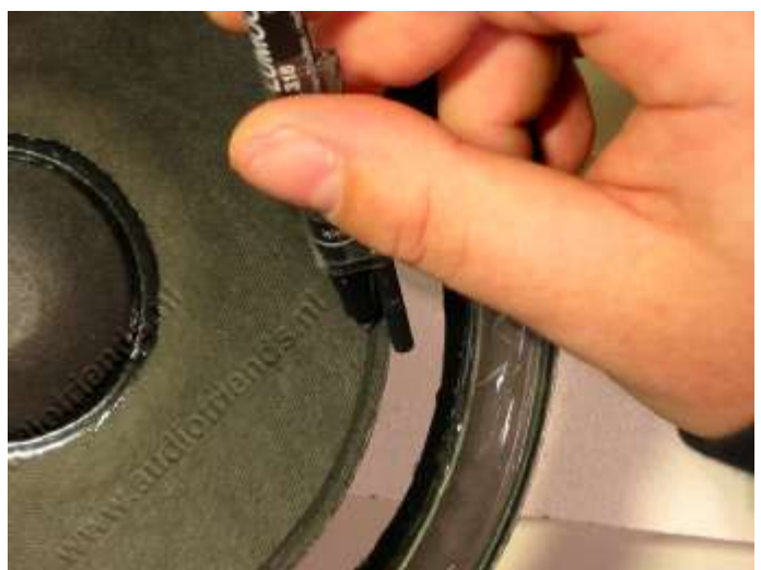
16. Kijk wel goed of de richtlijn straks onder de foamrand komt. Let op! De oude plakrand hoeft niet persé overal even breed te zijn.
